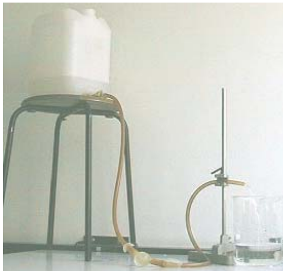
Bild 16: Simulationsversuch zum Aneurysma: der Luftballon im Schlauch bläht sich auch bei konstantem Druck bis zum Platzen auf.
