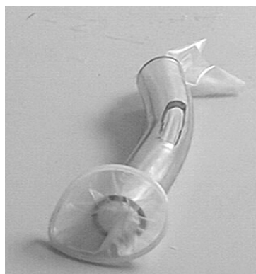
Bild 9: In einen dickwandigen Schlauch ist ein Loch geschnitten, das mit einem dünnwandigen Schlauch ausgekleidet wurde. Damit kann die Auswirkung des Schweredruckes auf eine Vene simuliert werden.
