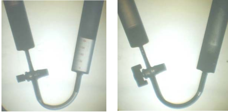
Bild 1a, b: Fotos der Versuchsanordnung zur Demonstration des Ausdehnungsbestrebens von Gasen.
