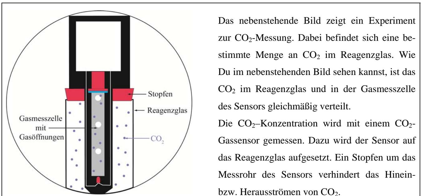
Der IR-Detektor misst wie viel der ausgesandten IR-Strahlung durch die Gasmesszelle kommt.
