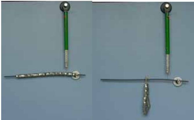
Bild 3: a) Das Armmodell ist unterteilt in 40 gleiche Teile. b) Werden alle Teile bei L/2 angehängt, ergibt sich das gleiche Drehmoment.
