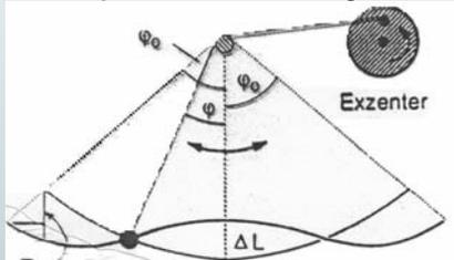
Parametrischer Oszillator als Fadenpendel
